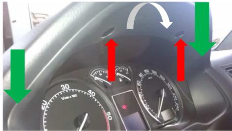
aus dem Rahmen ausclipsen (nach unten drücken) und die Verkleidung nach vorne abziehen.
